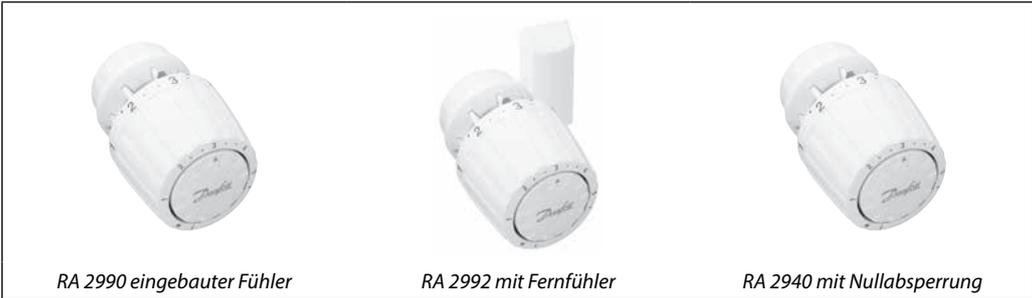
Die Fühler Elemente RA 2000 sind selbsttätige Proportionalregler mit Gasfüllung mit einem spezifischen Hub von 0,37 mm/K. Sie bieten beste Regelqualität und höchste Energieeinsparung und sind für Planungen nach DIN V 4701/10 und AP-Bereich  $\leq 1K$  geeignet (EnEV).
