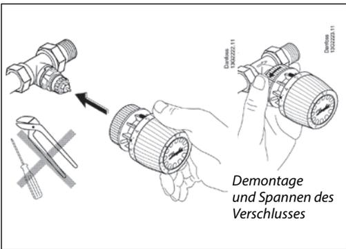
Die Montage des Fühler Elementes auf das Ventilgehäuse ist sehr einfach und erfolgt ohne Werkzeug: Fühler Element aufsetzen, festdrücken und fertig.
