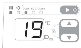
Le voyant de mode reste allumé pour vous permettre de visualiser le mode en cours. L'écran passe en veille. Faites un nouvel appui sur une des touches pour visualiser la température.
