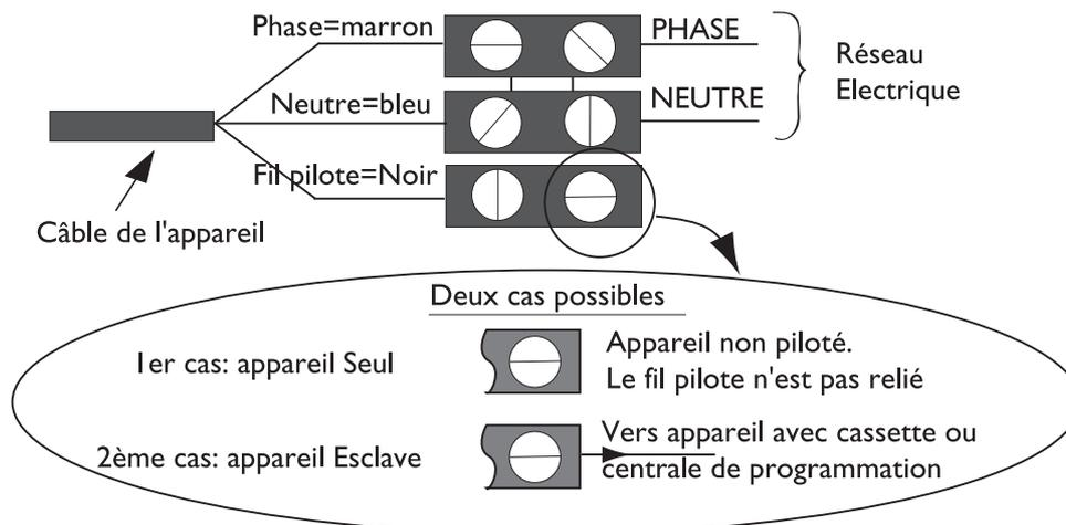
Vous pouvez raccorder le fil pilote si votre maison est équipée d'une centrale de programmation, d'un programmateur ou d'un gestionnaire, ou si votre générateur est muni d'une sortie fil pilote compatible.
