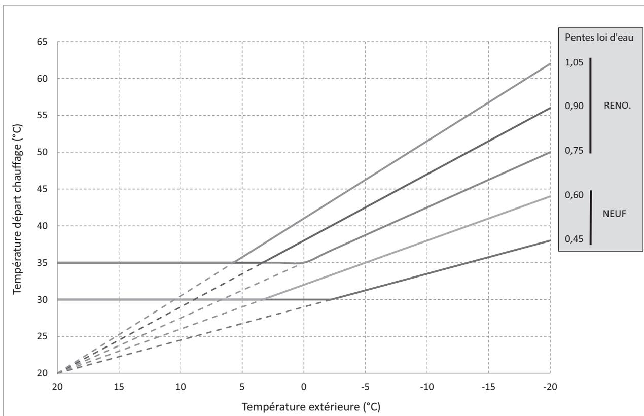
Veillez régler la température minimale de départ du circuit de chauffage dans la zone Radiateur Dynamique à :
