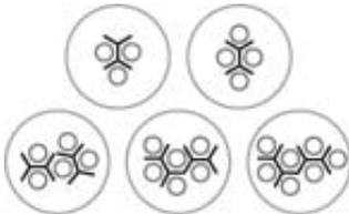
Bei Belegung mit drei oder mehr Kabeln sind RDSS Clips (Abdichtsterne) in Kombination mit der Abdichtmanschette RDSS zu verwenden. Ein RDSS Clip kann bis zu vier Kabel abdichten. Werden mehr als vier Kabel eingeführt, ist für jeweils drei zusätzliche Kabel ein weiterer Abdichtstern zu verwenden.
