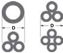
Bestimmung des Kabel(bündel)-durchmessers  $D$  und Auswahl der passenden Abdichtmanschette RDSS nach Auswahltabelle. Bitte beachten Sie, dass für jeden RDSS Clip (Abdichtstern) 5 mm zum Kabelbündel hinzugerechnet werden müssen.
