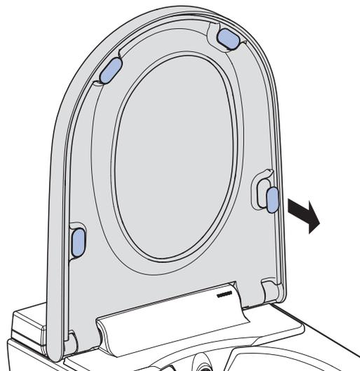
**3** Setzen Sie passende Ausgleichspuffer ein.
