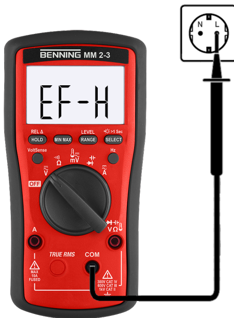
Illustration 15: Contrôle du conducteur extérieur ou test de phase
