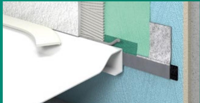
Angebracht wird der MEPA Schnittschutz entweder direkt auf Aquaproof (links) oder auf die letzte Schicht der Verbundabdichtung (rechts).
