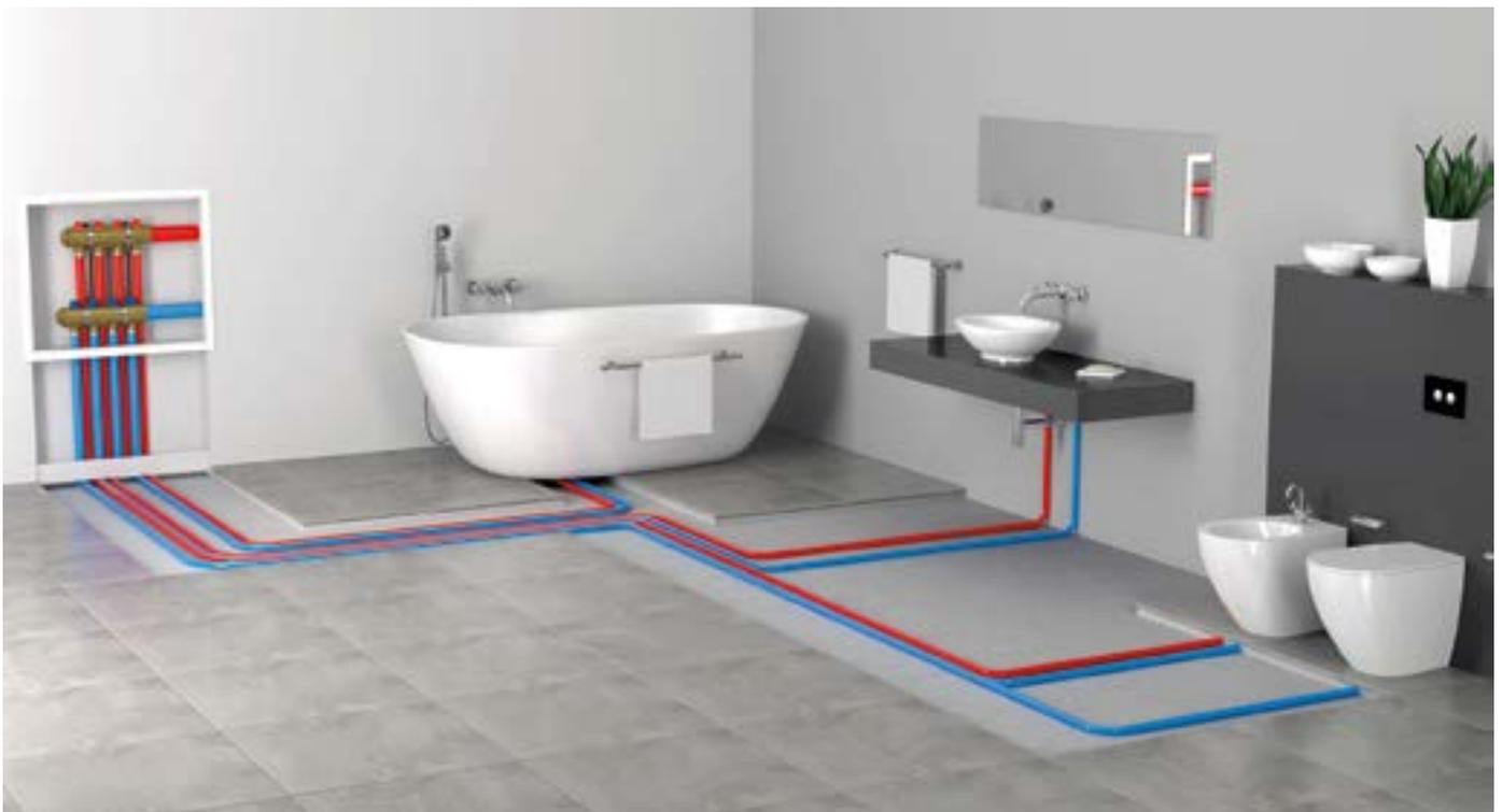
Sanitäranlage mit vorisoliertem Mehrschichtverbundrohr installiert, bzw. mit farbigen gewellten Rohr
