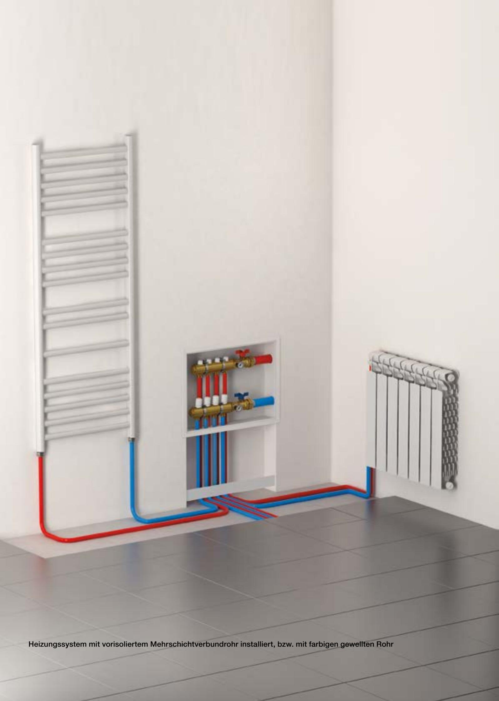
Heizungssystem mit vorisoliertem Mehrschichtverbundrohr installiert, bzw. mit farbigen gewellten Rohr
