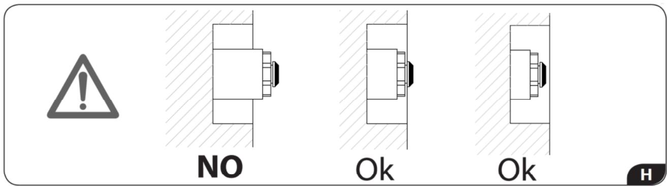
Attenzione: per una corretta installazione il raccordo di alimentazione con terminale esagonale deve essere installato al massimo a filo muro.
