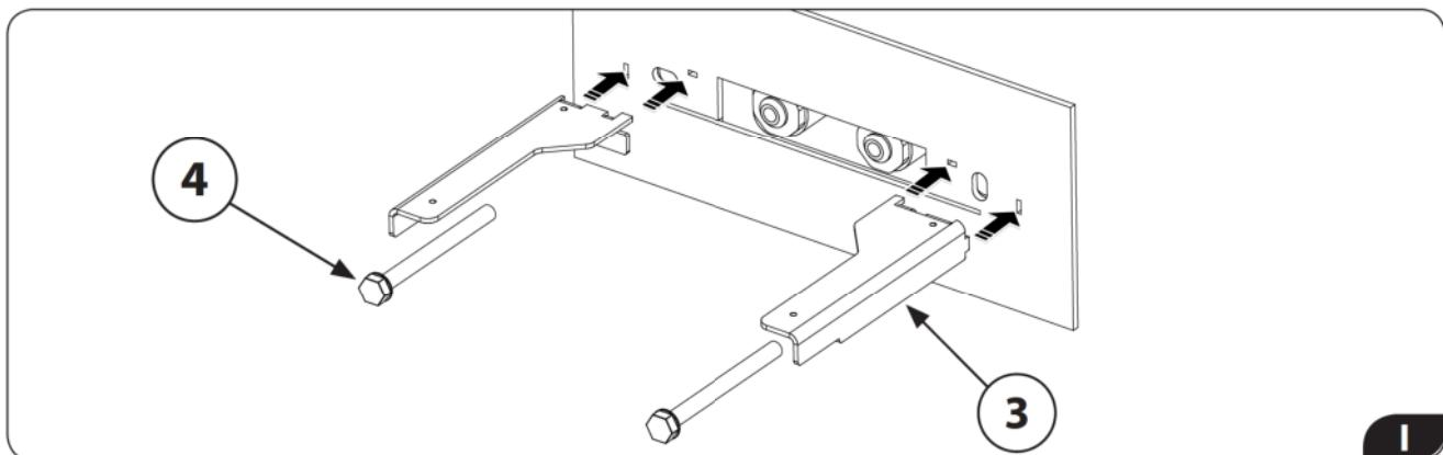
Le viti e i tasselli forniti in dotazione sono idonei per installazioni su pareti piene, in calcestruzzo, pietra o materiale compatto. Nel caso in cui la parete sia di questo tipo, per una corretta installazione il soffione deve essere fissato a parete esclusivamente con le viti e i tasselli forniti o con versioni equivalenti.
