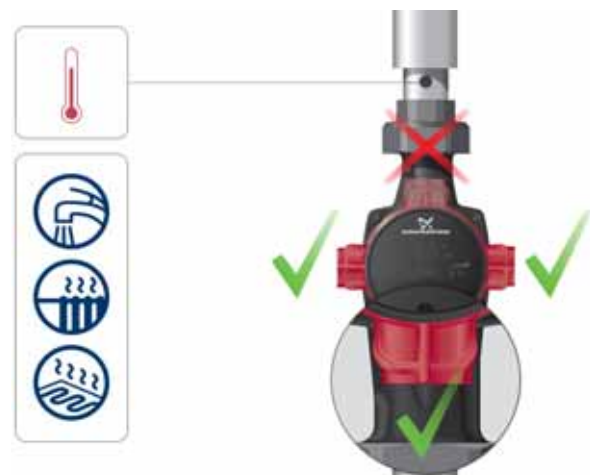
Abb. 3 Position des Schaltkastens in Heizungs- und Trinkwarmwasseranlagen
