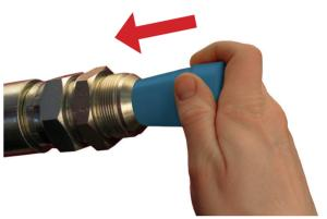
c) Tourner vigoureusement le Stop-fuite dans l'orifice ou le filetage.
