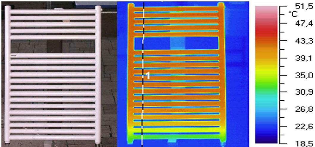
Die unten dargestellte Graphik zeigt die an der senkrechten Achse gemessenen Temperaturen, welche mit 1 in der thermographischen Abbildung dargestellt sind. Die oberen Spitzen repräsentieren die Temperatur der waagerechten Röhren, während die unteren Spitzen auf die Abstände zwischen den Röhren zurückzuführen sind. Alle Röhren, außer den 3 unteren, verfügen über eine Oberflächentemperatur zwischen 40 und 43 °C.
