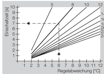
Bei einer Regelabweichung von 6 °C wird der Mischer 7 s angesteuert und bleibt 3 s aus.
