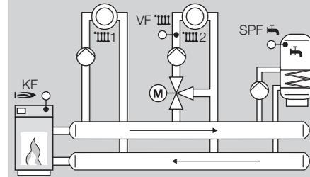
Wärmeerzeuger-Fühler (KF/KFS), Vorlauffühler (VF/VFS) und Speicherfühler (SPF/SPFS) anschließen,
