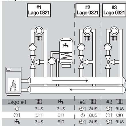
Anlage mit drei gemischten Heizkreisen und Warmwasserbereitung: Lago #1 regelt den ersten Heizkreis und Warmwasser. Lago #2 regelt den zweiten Heizkreis und Lago #3 den dritten. Wenn für Lago #1 die Betriebsart ☉ gewählt wurde, wird die gesamte Anlage ausgeschaltet, unabhängig von der Einstellung der anderen Regler.
