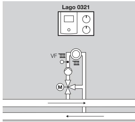
Diese Anwendung wird automatisch aktiviert, wenn nur ein Vorlauffühler (VF/VFS) angeschlossen wird.
