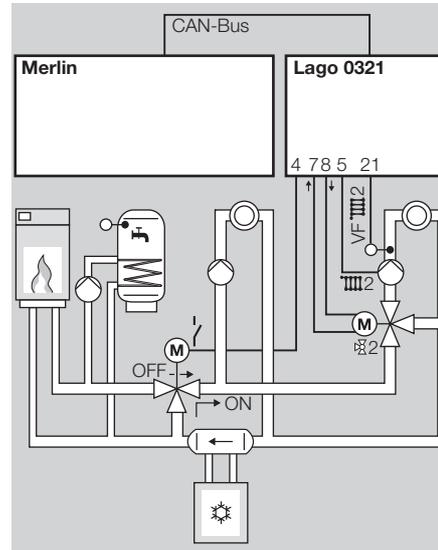
Der Zentralregler aktiviert die Betriebsart „Kühlen“ über den CAN-Bus und steuert den Wärmeerzeuger, die Kältemaschine, die Warmwasserbereitung und den direkten Heizkreis. Der Lago 0321 steuert das Bypassventil und den gemischten Heizkreis.
