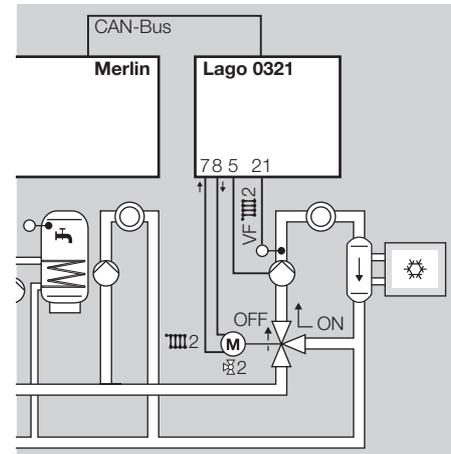
Der Mischer im Heizkreis arbeitet als Ventil. Der Mischer fährt auf (ON). Die Heizkreispumpe ist eingeschaltet.
