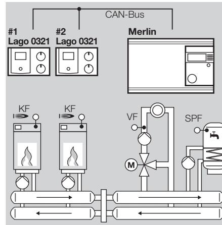
Diese Anwendung wird automatisch aktiviert, sobald Sie einen Wärmerezeuger-Fühler (KF/KFS) anschließen und Parameter 38 = 1–8 (Adresse Heizmodul) einstellen.
