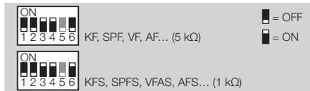
Bei Anschluss einer Fernbedienung den DIP-Schalter 5 einstellen:
