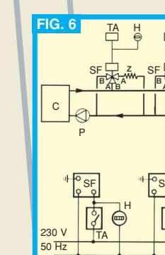
**ESEMPIO DI APPLICAZIONE PRECEDENZA BOLLITORE** Questo sistema di installazione da noi usato prevalentemente su caldaie combinate permette la regolazione di temperatura del bollitore al valore desiderato. La valvola viene usata come precedenza rispetto all'impianto.
