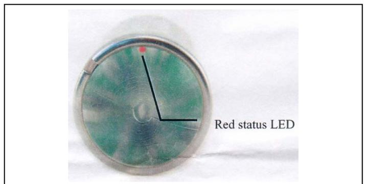
**Bild 1** - Wenn der Sender eingeschaltet ist, blinkt die rote LED langsam. Wenn die Batterie nicht mehr genug Leistung bringt um einen einwandfreien Betrieb zu gewährleisten, blinkt die rote LED schnell. Sollte die LED nicht blinken, bitte legen Sie eine neue AAA Batterie ein.
