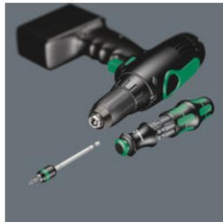
Die Sets der Reihe Kraftform Kompakt 20 haben's in sich: Im Griff versenkbare Teleskopklinge (die auch herausgenommen und als Bit-Halter in die Schraubmaschine eingesetzt werden kann) und integriertes Bits-Magazin. Mit der Rapidaptor-Technologie ist der blitzschnelle Bit-Wechsel sowie eine gute Führung durch die Freilaufhülse beim Maschinenbetrieb garantiert.
