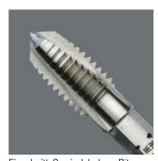
Einschnitt-Gewindebohrer-Bit Einsatz: Zum Schneiden von Gewinden • 1/4"-Antrieb passend für Halter nach DIN 3126-D 6,3 (ISO 1173) • Sehr gute Kraftübertragung durch Sechskant-Schaft • Fein abgestimmte Material- Elastizität für hohe Sehr Standzeiten • Zentriereigenschaften Problemloses Schneiden Einwandfreie Spanabfuhr Geringe Verkantungsgefahr Präzise Rücklaufführung • Hoher Korrosionsschutz
