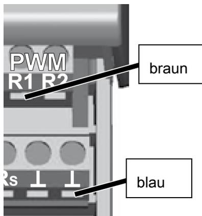
Anschluss Steuerleitung der PWM-Pumpe ≤ 15 V
