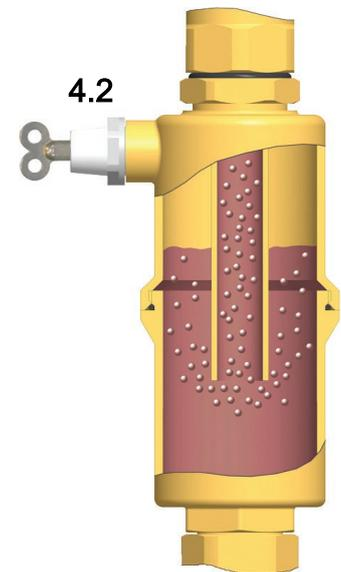
Die aus der Solarflüssigkeit abgeschiedene Luft sammelt sich im oberen Bereich des Luftfangs und kann über den Entlüfterstopfen [4.2] abgelassen werden.
