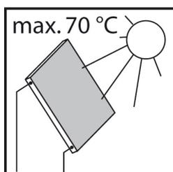
Bei Sonnenschein heizen sich die Kollektoren sehr stark auf. Der Wärmeträger im Solarkreis kann sich auf über 100 °C erhitzen. Spülen und befüllen Sie den Solarkreis nur bei Kollektortemperaturen unter 70 °C.
