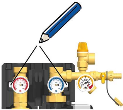
3. Übertragen Sie die Befestigungslöcher neben den Thermometern der Solarstation auf die Montagefläche.
