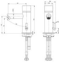
Hydraulisch gesteuerte Selbstschlussarmatur:
