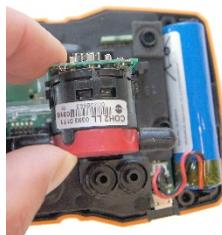
2 Retirer les raccords de tuyau du capteur défectueux/du pont.
