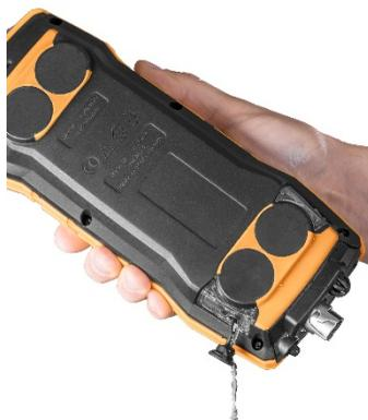
3 - Tamponner les gouttelettes sur l'évacuation du condensat avec un chiffon et fermer l'évacuation du condensat.
