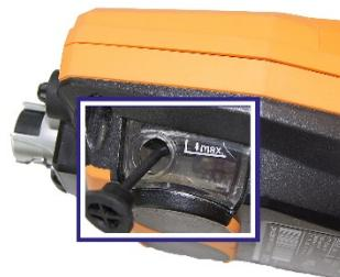
2 Laisser s'écouler le condensat dans un bassin.
