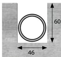
Schlitzten von Rohrkanälen (randnah bis 15 mm)
