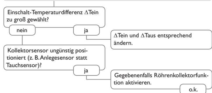
Pumpe läuft kurz an, schaltet ab, schaltet wieder an usw. („Reglerflattern“)
