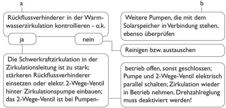
Die Solarkreispumpe läuft nicht, obwohl der Kollektor deutlich wärmer als der Speicher ist
