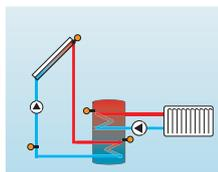
Die Thermostatfunktion arbeitet unabhängig vom Solarbetrieb und kann für eine Überschusswärmennutzung oder zur Ansteuerung der Nachheizung genutzt werden.
