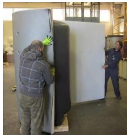
L'approche des bords doit être fait sur l'ensemble du paquet isolant et non seulement sur le revêtement extérieur qui pourrait se déchirer.
