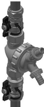
(DE) 4. Spül- / Entlüftungsschlauch an den Spülanschlüssen anschließen, Absperrkugelhähne wieder öffnen und Anlage spülen.
