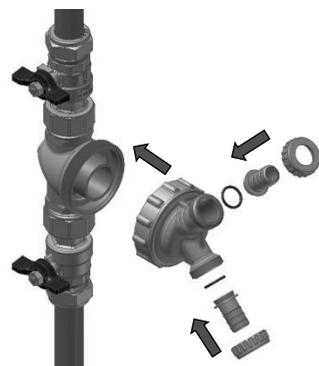
(DE) 3. Spüladapter auf Einbaugehäuse montieren. Auf richtigen Sitz des Dichtung-O-Rings achten.
