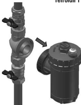
(DE) 2. Filterkörper von Einbaugehäuse entfernen.
