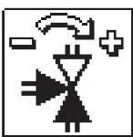
Wählen Sie das richtige Drehrichtung zum Öffnen des Mischventils. Zwischen Linke und Rechte Drehrichtung bewegt man sich mit den Tasten – und +. Das ausgewählte Drehrichtung Bestätigt man mit der Taste ✓.
