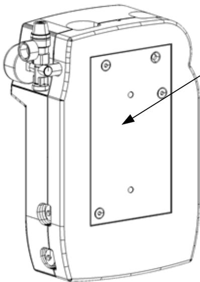
Rückseitige Stahlplatte für die Befestigung an der Wand oder am Speicher.
