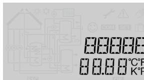
L'indicateur de canaux est composé de deux lignes. La ligne supérieure est une ligne alphanumérique à 16 segments indiquant principalement le nom des canaux et les différents sous-menus. La ligne inférieure à 16 segments affiche des valeurs.
