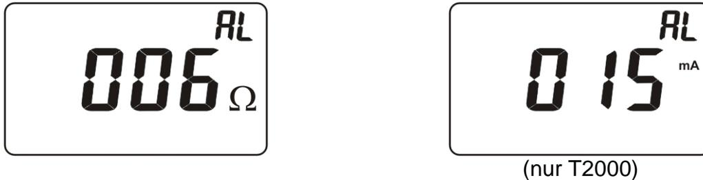
Abb. 39: Einstellung von Alarm-Schwellen bei Widerstands- und Strommessungen
