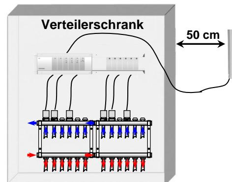
Für eine maximale Empfangsleistung der Antenne sollte diese mit einem Abstand von mindestens 50cm zu metallischen Oberflächen oder vertikalen metallischen Rohren, installiert werden.
