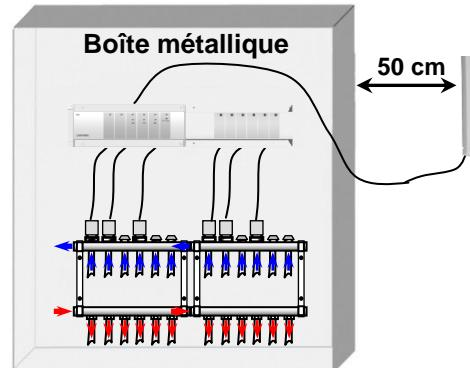
\* Pour une sensibilité radio maximale, l'antenne doit être placée à une distance minimale de 50 cm d'une surface métallique (boîte métallique) ou des tuyaux métalliques verticaux.
