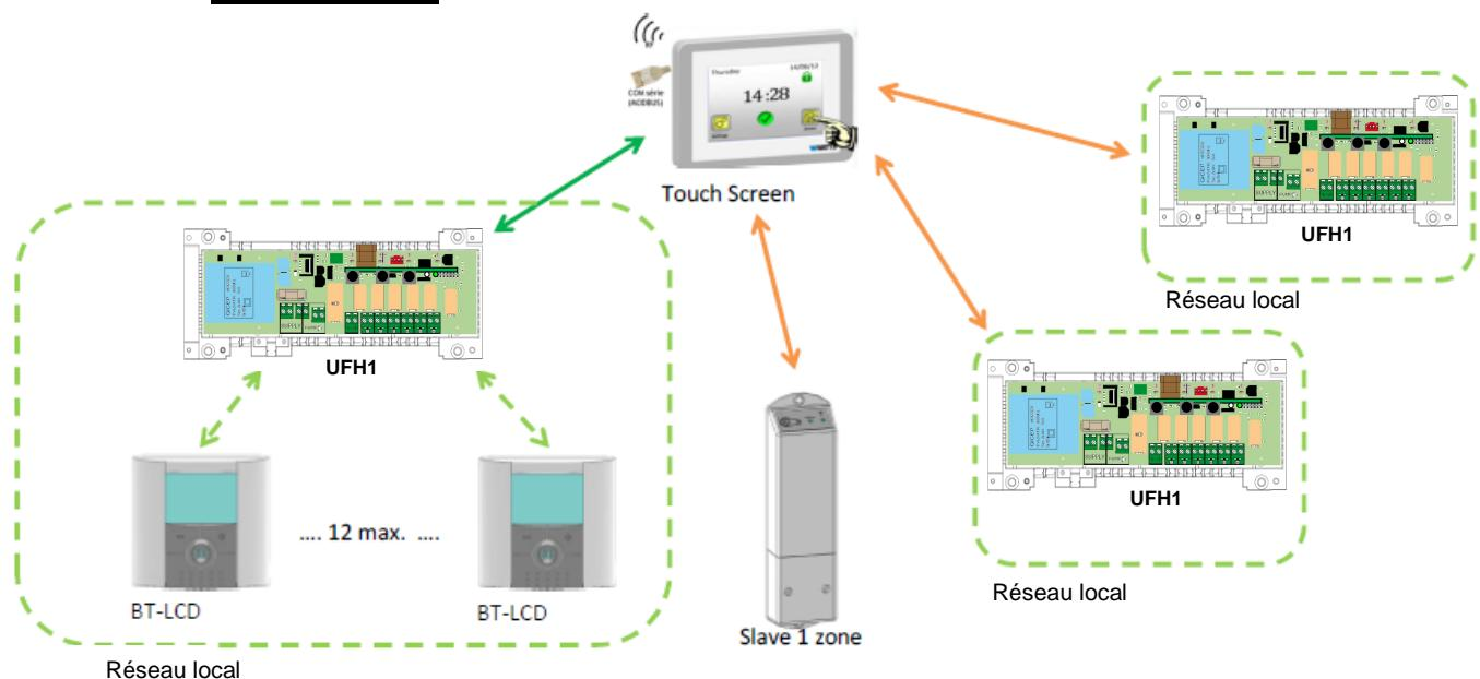
Attention! La centrale doit être appairée avec le master en dernier (quand tous les thermostats sont appairés)
