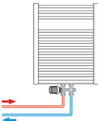
Heizkörper oder Konvektor mit Stellantrieb EMO T
