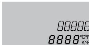
Die Kanalanzeige besteht aus 2 Zeilen. In der oberen 16-Segment-Anzeige werden hauptsächlich Kanalnamen/Menüpunkte eingeblendet. In der unteren 7-Segment-Anzeige werden Werte angezeigt.
