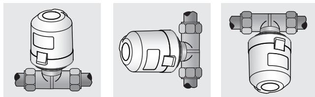
Der Antrieb ist bevorzugt in senkrechter und waagerechte Montagelage einzubauen. Bei "über Kopf"-Montage können spezielle Umstände (z.B. Schmutzwasser) die Lebensdauer reduzieren.
