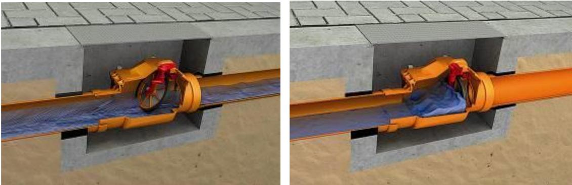
Natürlicher Durchlauf des Regenwassers. Zurücklaufen des Wassers, sog. „Rückstau“.
