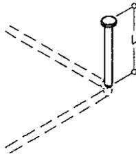
Das Montageset MS 1.9 ist mit einer langen Mutter (Verbindungsmutter) an die innenliegende Gewindestange gekoppelt. Das Montageset wird abgeschraubt und die Gewindestange und das Rohr in der gleichen Länge gekürzt. Die horizontalen Schenkel sind wie oben beschrieben ausgebildet und können ebenso bauseits gekürzt werden.
