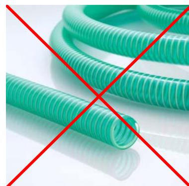
Dans le périmètre d'aspiration, on ne pourra pas utiliser de tuyaux flexibles, vu que le tuyau intérieur est mou et qu'il se rétracte en cas de sous-pression.
