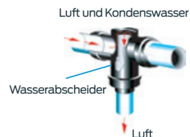
Bei der Installation dieses Verbinders ist darauf zu achten, dass eine horizontale Verlegung des Verbinders gewährleistet ist. Der Verbinder ist entsprechend gekennzeichnet, so dass eine Falschmontage ausgeschlossen werden kann.
