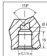
Arrivée 1 et retour 2 avec étanchéité directe pour les modèles révision 6 (l'étanchéité avec rondelle sur lamage reste possible)
