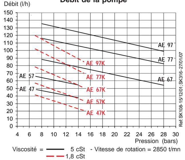
Les caractéristiques indiquées tiennent compte d'une marge d'usure. Ne pas surdimensionner les pompes lors du choix de la capacité d'engrenage.
