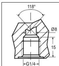
Arrivée ① et retour ② avec étanchéité directe pour les modèles révision 6 (l'étanchéité avec rondelle sur lamage reste possible)
