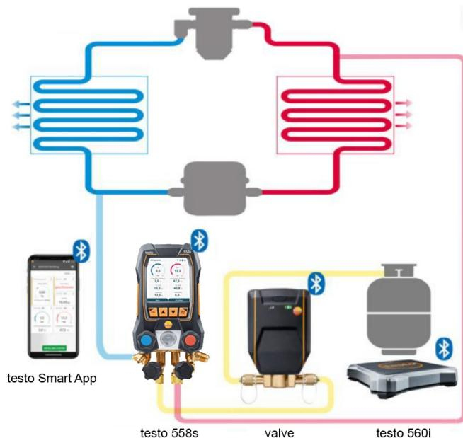
In Kombination mit **testo 560i** und dem **testo Smart Valve** bietet die Monteurhilfe **testo 558s** mehrere Funktionen zur Befüllung von Kältemittelkreisläufen an.
