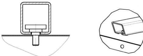
1. Einschieben bis linke Noppenschraube freiliegt
