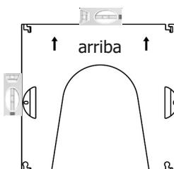
2. Identifique con lápiz el punto de perforación seleccionado en las marcas especificadas. Perfore con la broca adecuada respectivamente orificios horizontales en los 2 puntos de perforación marcados y limpie los orificios de perforación.
