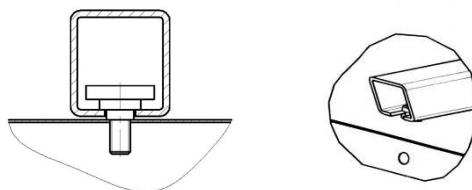
1. Insérer jusqu'à ce que la vis à noppes soit dégagée
