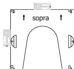
Grazie alla nostra tecnica, è possibile installare i radiatori a infrarossi design sia in verticale che in orizzontale, senza dover lasciare segni sugli elementi. Utilizzare la livella (appoggiandola sulla sottostruttura) e posizionate a filo la sottostruttura.
