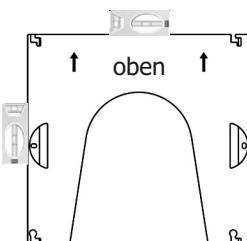
2. Kennzeichnen Sie mit dem Bleistift die gewählte Bohrstelle an den vorgegebenen Markierungen.
