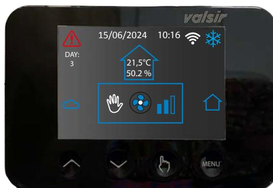
Durch gleichzeitiges Drücken der Tasten 1 und 2 (Pfeil nach oben und Pfeil nach unten) werden die Alarme angezeigt:
