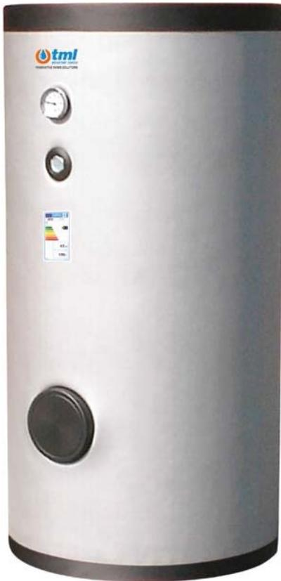
Warmwasserbereiter aus Edelstahl AISI 316L für die Erzeugung und Speicherung von Sanitärwasser (Trinkwasser). Sie sind mit einem oder zwei fixen internen Rohrschlangenswärmetauschern ausgestattet, die von einer Wärmepumpe und Solarsysteme einem herkömmlichen Heizkessel gespeist werden können. Der spezielle Wärmetauscher mit doppelter Parallelschleife ermöglicht eine effizientere Übertragung der von der Wärmepumpe
