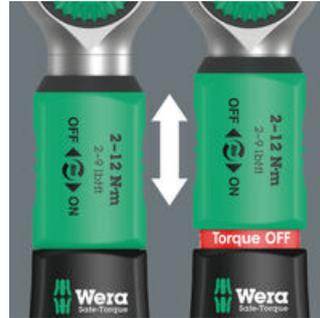
Die Drehmomentfunktion kann ausgeschaltet werden. Der Drehmomentschlüssel Safe-Torque kann dann auch als Standard-Knarre mit hohen Lösemomenten und bei definierten Drehwinkel-Anwendungen eingesetzt werden.
