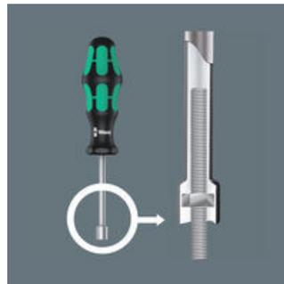
Bei Verschraubungen an Gewindestangen sind Schraubendreher mit Hohlschaft nützlich, denn die Gewindestange kann in den hohlen Schaft des Schraubendrehers eindringen und die Schraubenmutter betätigt werden.
