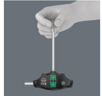
Die Klemmung der Innensechskant-Schraube auf der Werkzeugspitze wird durch eine federnde Kugel gewährleistet. Besonders hilfreich in schwer zugänglichen Arbeitsbereichen, wo man die zweite Hand nicht zum Festhalten der Schraube nutzen kann.
