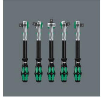
Der Knarrenkopf ist frei schwenkbar und kann durch den beidseitig angebrachten Schiebeshalter in jeder Fixierungsposition verriegelt werden. Problemloses Arbeiten mit großem Handfreiraum ist selbst in sehr engen oder schwer zu erreichenden Einbausituationen möglich. Die definierte Fixierung bei 0°, 15° und 90° nach links und rechts garantiert sicheres Arbeiten ohne Verrutschen des Knarrenkopfes.
