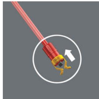
Schraubkralle auf die Klingenspitze des Schraubendrehers schieben bis das Klingprofil aus der Gummi-Klingenaufnahme heraustritt.
