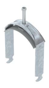
Bügelschelle mit Hammerkopf-Fuß, Kunststoffdruckwanne aus Polypropylen. Zur vertikalen und horizontalen Montage von 1 Einzelkabel an C-Profilschiene. Für Schlitzweite 16 - 17 mm. Mit 1-gängiger Schraube an Druckwanne, universeller Sechskant-Schraubenkopf SW10, mit Schlitz und Kreuzschlitz. Geeignet für Montage im Innen-und Außenbereich. Der Einsatz einer Gegenwanne wird empfohlen.
