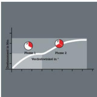
Bei Einsatz des BiTorsion-Halters erhöht sich die Lebensdauer konventioneller Bits, der BiTorsion-Bit funktioniert auch mit einem normalen Halter.
