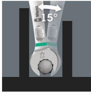
Der Doppelmaulschlüssel Joker 6005 mit seiner besonderen Maulgeometrie - eine um 7,5° geschwenkte Maulseite und die Doppelsechskantgeometrie - verdoppelt die Ansetzmöglichkeiten bei wiederholter 180°-Drehung des Schlüssels um die Längsachse. Muttern bzw. Schraubenköpfe können alle 15° "gepackt" werden. Den jeweiligen Ansetzpunkt findet der Joker 6005 nach jedem Wenden sozusagen von selbst.
