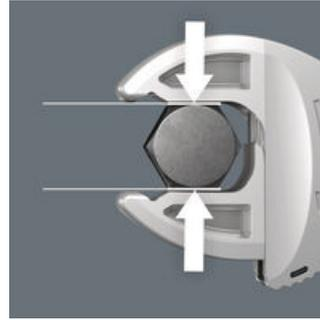
Die parallelen glatten Backen des Joker 6004 ermöglichen eine Flächenpressung und können dadurch das Verrunden der Mutter bzw. des Schraubenkopfes vermeiden, was bei der Kraftübertragung über Ecken auftreten kann.
