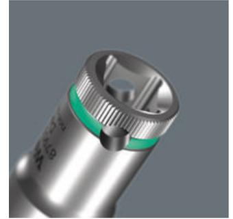
Hand- und Maschinensteckschlüssel-Einsätze (ISO 2725-Teil 3) für den Einsatz im Hand- und Maschinenbetrieb. Mit Take it easy Werkzeugfinder mit Farbkennzeichnung nach Größen - zum einfachen und schnellen Finden des benötigten Werkzeugs. Griffig zum leichten Greifen auch mit öligen Händen. Mit Kugelfangrille. Für Außensechskantschrauben- und muttern. Aus mattverchromtem Chrom-Vanadium.
